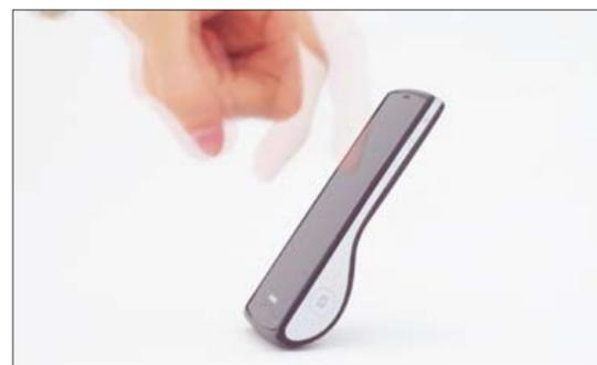
بساطة قام المصمم (جيريمي إينيس هويكينز) بتصميم جهاز يقوم بتحويل المعلومات الرقمية من المكالمات أو الرسائل أو البريد الإلكتروني القادمة إلى الجهاز إلى طاقة حركية يقوم الجهاز باستخدامها، أي عندما يرن هاتفك، أو يصلك مسج من أحد الأشخاص سوف يقوم الهاتف بالنهوض من الطاولة ليخبرك بوصول
